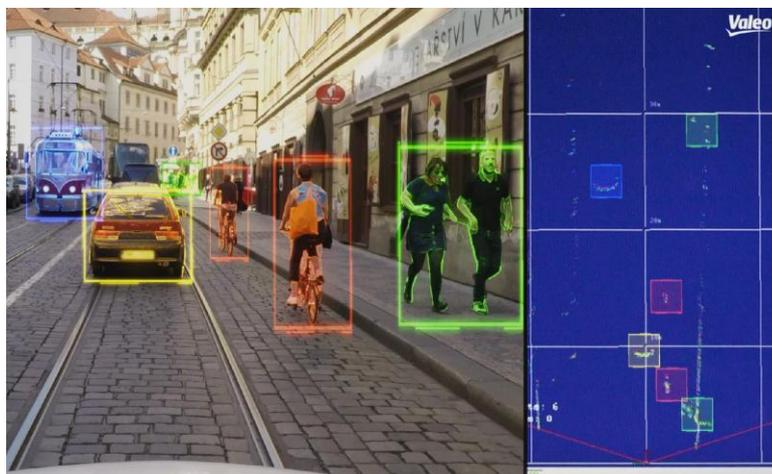
Вращающиеся зеркала лидара ловят свет, отражённый от препятствий, создавая тем самым образ окружения автомобиля. Положение зеркал в каждый момент времени фиксирует специальный датчик.
