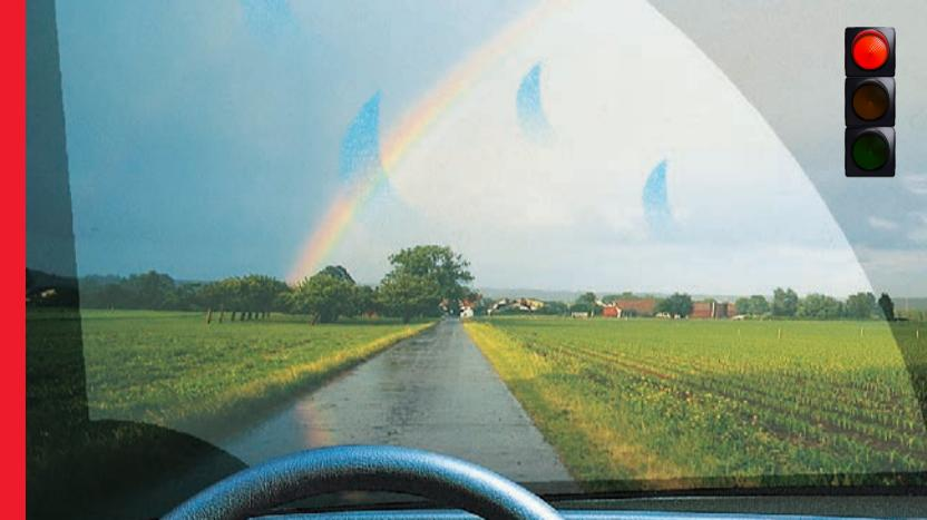
Если стеклоочиститель «пропускает» некоторые области стекла на большой скорости, замените щетки стеклоочистителя и проверьте рычаг стеклоочистителя на предмет повреждений или износа и при необходимости замените его.
