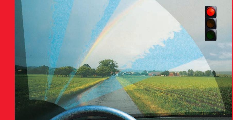
Остаточная деформация чистящего резиноэлемента, изношенный рычажный механизм привода или рычаг стеклоочистителя могут быть причиной того, что щетка перемещается по стеклу резкими толчками, оставляя неочищенные радиальные полосы. Замените щетки стеклоочистителя и, при необходимости, компоненты рычажного механизма привода.
