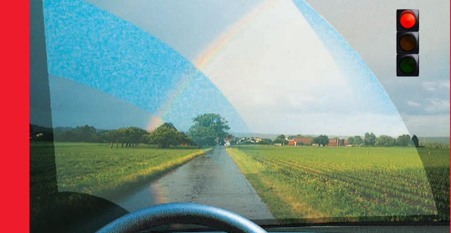
Повреждение рычажного механизма привода щетки стеклоочистителя или снижение прижимного усилия рычага стеклоочистителя может привести к тому, что некоторые части ветрового стекла останутся неочищенными.
