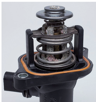
Рисунок 1: Отчетливые следы коррозии на управляемом термостате (тип TM)
