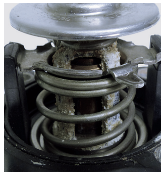
Рисунок 2: Антифризы без соответствующих допусков буквально разъедают алюминий.
