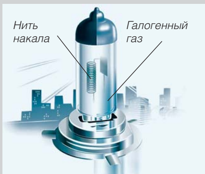
Галогенный газ вступает в реакцию с испаряемыми атомами вольфрама и возвращает их обратно на нить накала. Этот процесс позволяет увеличить срок службы нити накала.
